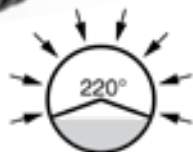
LP částečně perforované drenážní trubky
