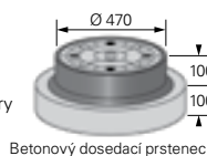
Betonový dosedací prstenec
