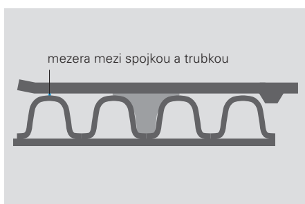
Předpisová montáž s normální mezerou na spojce o velikosti 1–2 mm.
